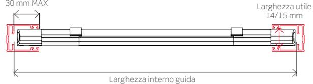
La larghezza del telo finito si ottiene sottraendo da 8 a 10 mm alla misura utile dell'interno guida (**riferito esclusivamente alle guide presenti in questo catalogo**).
