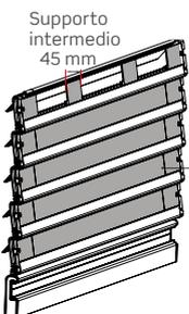
Quando la larghezza del telo eccede i 2801 mm e fino a 3300 mm, le 4 lamelle orientabili poste a ridosso del terminale, vengono fornite con un rinforzo di larghezza pari a quella del telo, di conseguenza le quattro lamelle diventano cieche.
