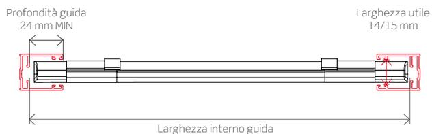
La larghezza del telo finito si ottiene sottraendo da 8 a 10 mm alla misura utile dell'interno guida (**riferito esclusivamente alle guide presenti in questo catalogo**).
