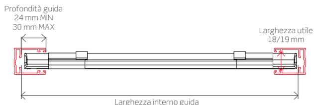
La larghezza del telo finito si ottiene sottraendo da 8 a 10 mm alla misura utile dell'interno guida (**riferito esclusivamente alle guide presenti in questo catalogo**).
